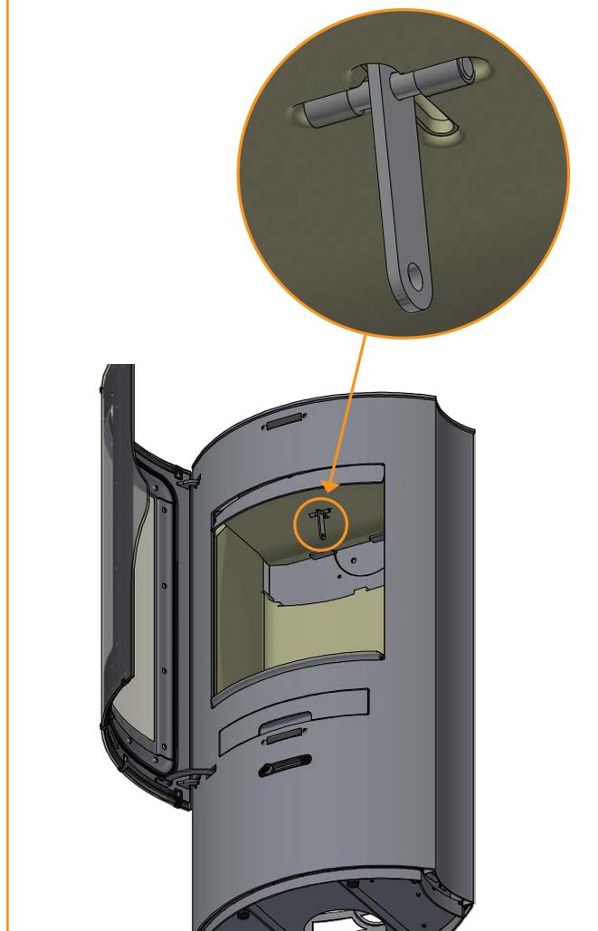
2 Ruotare il deflettore e abbassarlo nella camera di combustione
