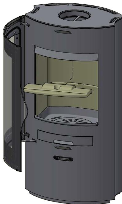
Sollevare delicatamente i fianchi e i pannelli posteriori del rivestimento interno della camera di combustione ed estrarli dalla stufa
