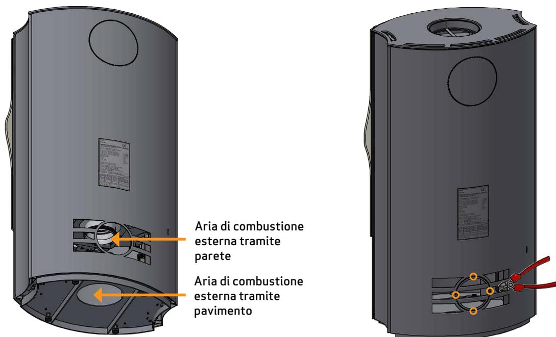
Se si desidera ricevere l'aria comburente esterna attraverso una parete, rimuovere la piastra di copertura sul retro della stufa con un paio di pinze taglienti
