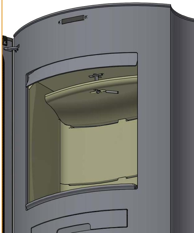
Ruotare il deflettore e abbassarlo nella camera di combustione
