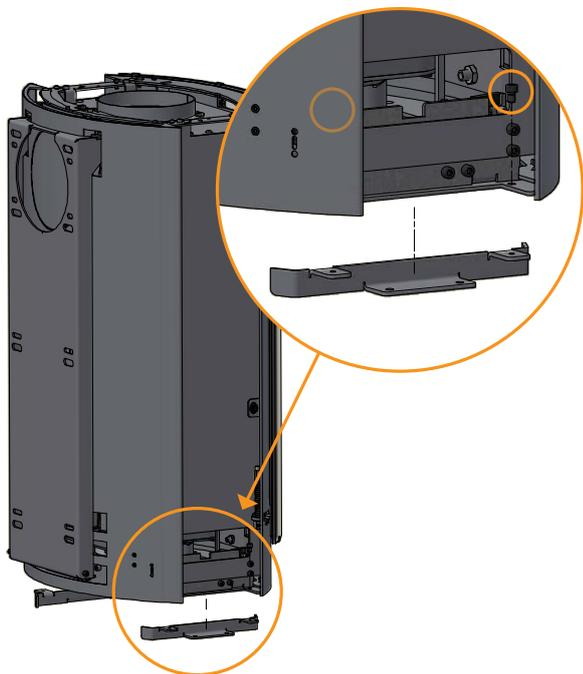
Rimuovere il supporto del pallet svitando le 2 viti che fissano il supporto del pallet alla stufa
