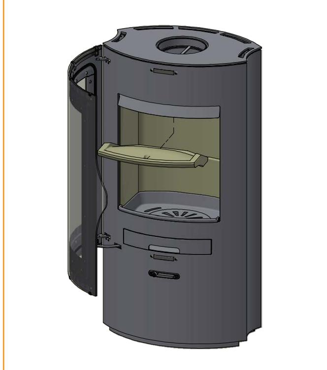
4 Montare la piastra deflettore superiore con il perno del deflettore e deflettore fumi inferiore rimontato successivamente
