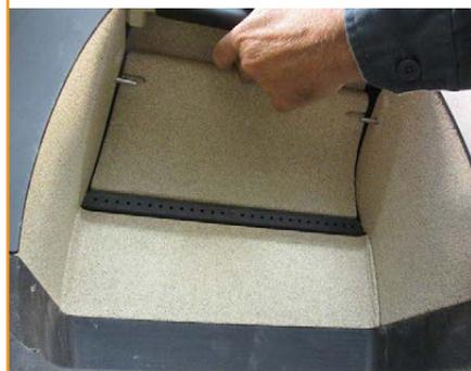
Tutte le piastre della camera di combustione sono ora montate **22**
