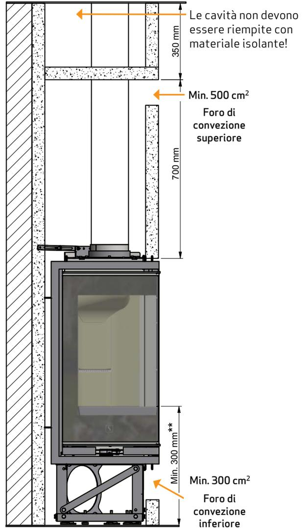
La distanza dalla parete ignifuga (mattoni) dipende dall'utilizzo di un condotto di scarico fumi isolato con isolamento fino in fondo all'inserto
