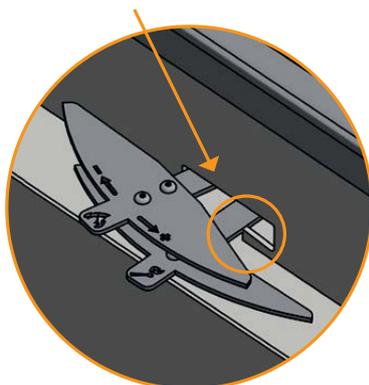
4 A stufa fredda, sollevare l'impugnatura della leva dell'aria primaria e poi spostarla completamente a destra.
