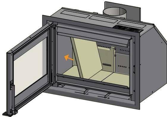
Le piastre posteriori della camera di combustione devono essere montate in modo che i fori delle piastre siano precisamente in posizione sopra i fori terziari dell'inserto
