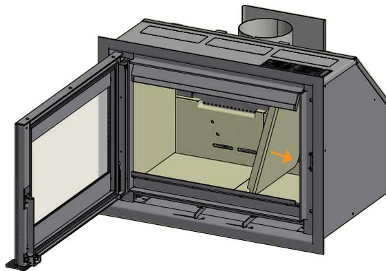
Montare la piastra deflettore fumi inferiore. La piastra deflettore deve essere sostenuta dalle piastre posteriori. Montare i perni e mettere in posizione il deflettore fumi
