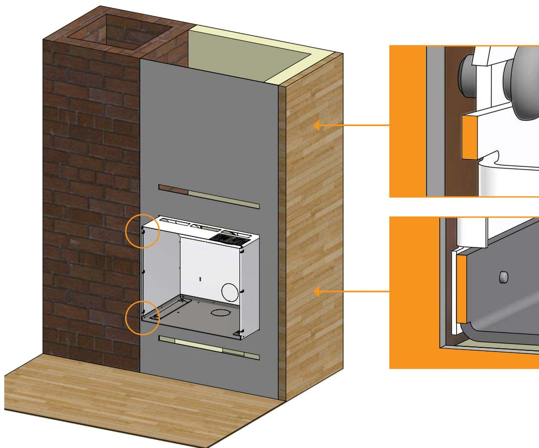
I punti di regolazione ai quattro angoli della cassetta deve essere a filo con il lato anteriore della struttura
