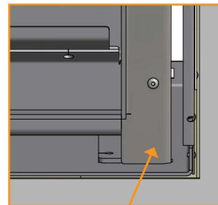
La parte inferiore della cassetta sostiene l'inserto
