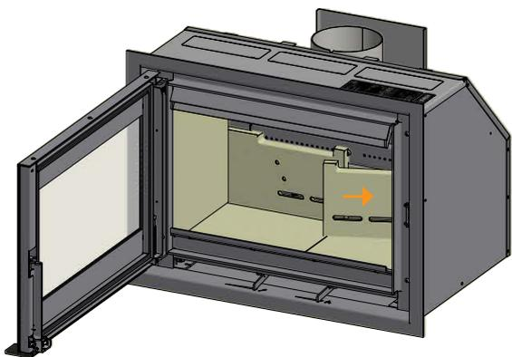
Montare la piastra destra della camera di combustione
