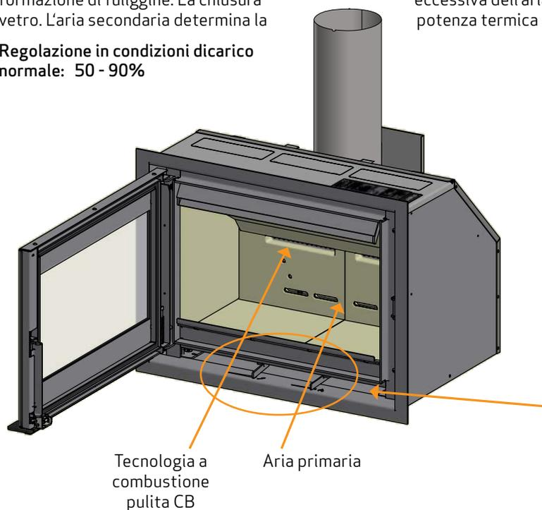
Regolazione alimentazione aria, valvola di tiraggio primaria e secondaria
