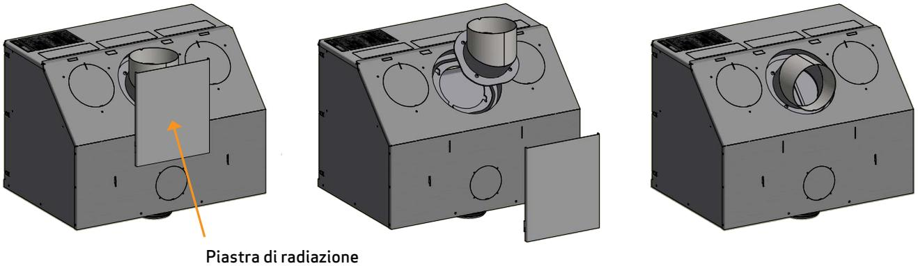
Montare la guarnizione da 3 x 8 mm sul bordo della flangia del raccordo. Fissare il raccordo con i dadi flangiati.
