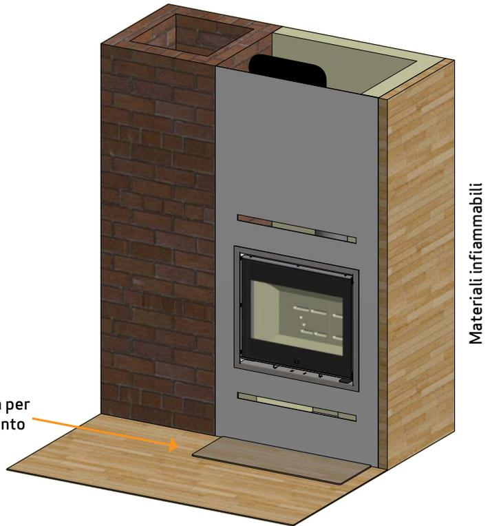
Queste piastre di copertura devono essere rimosse quando si esegue l'installazione dentro a materiale incombustibile protetto da isolamento
