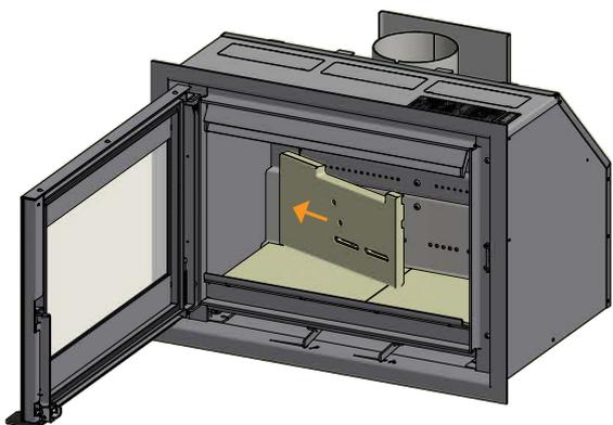
Montare la piastra sinistra della camera di combustione
